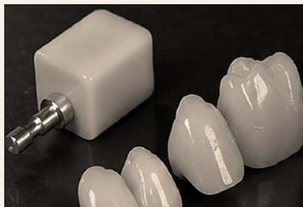
PIÈCES USINÉES ET BLOC DE MATÉRIAU LES ÉLÉMENTS SORTIS D'USINAGE, À CÔTÉ DU BLOC ET D'UN ANCRAGE.
